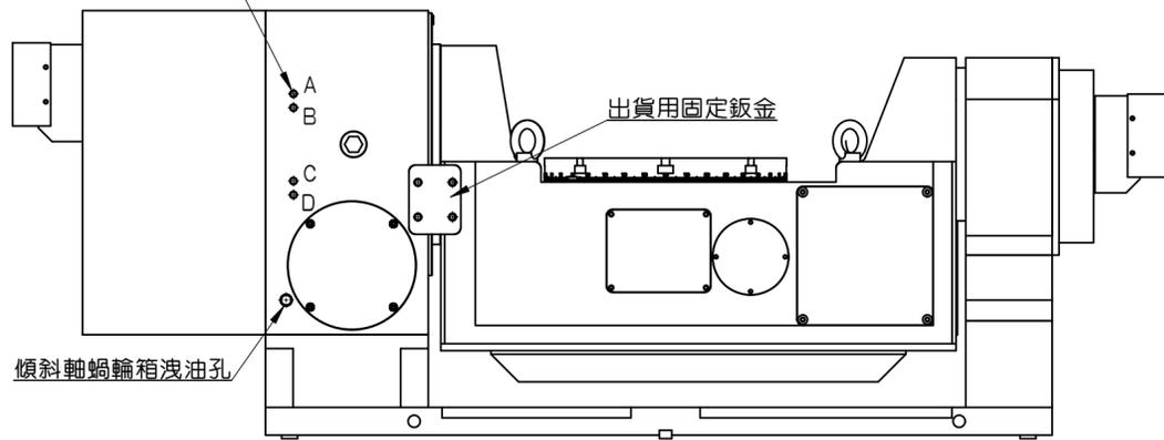
傾斜軸蝸輪箱洩油孔
