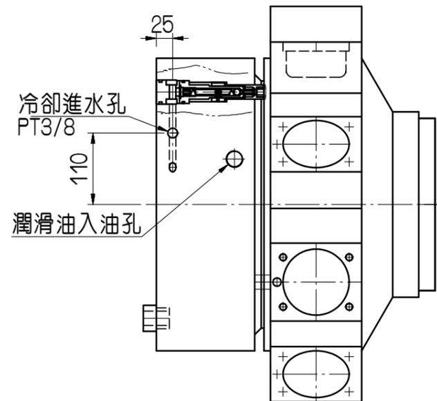
底部冷卻進水孔
