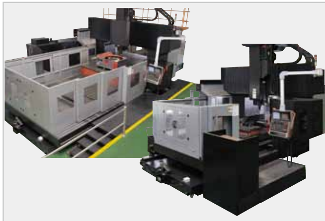
大型底座採用高精度龍門五面加工機
