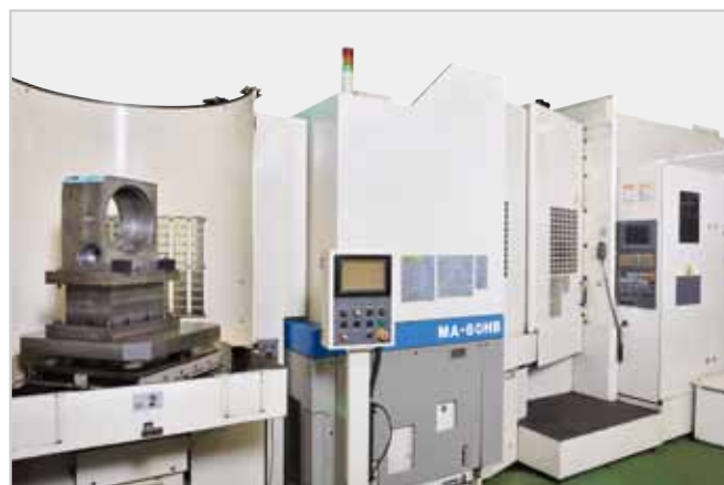
底座採用高精度臥式切削中心機
