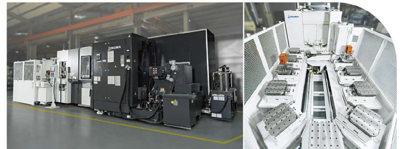
底座採用OKUMA臥式12盤加工中心機
