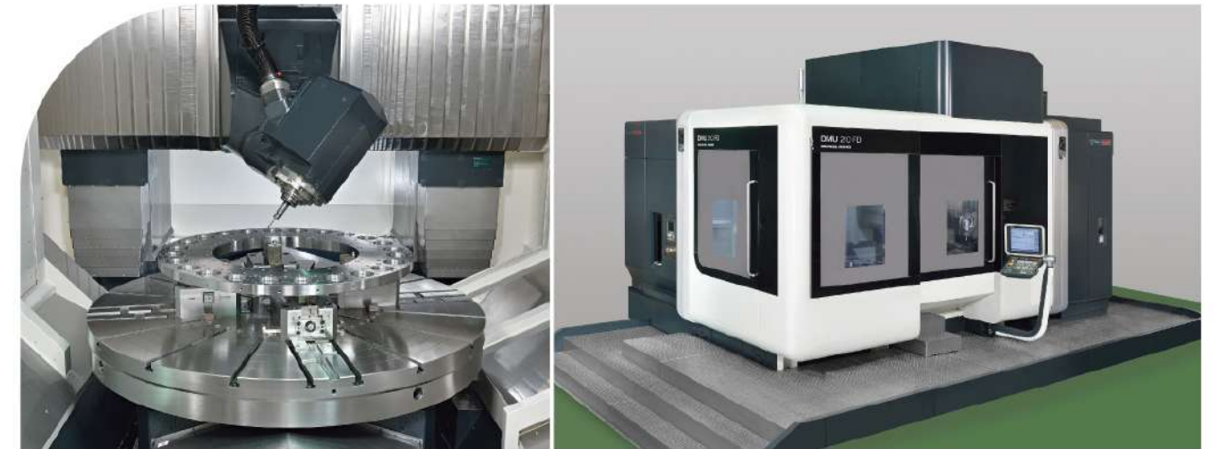
大型精密零件加工採用德製五軸車/銑/磨複合加工機
